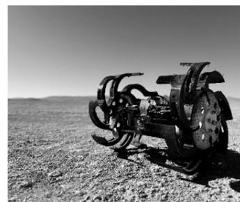
ロケットから投下し砂漠を走行した機体
